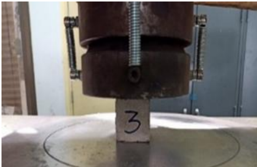
รูปที่ 3 การทดสอบกำลังรับแรงอัด
