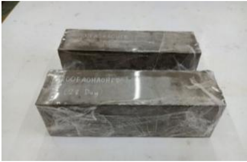
รูปที่ 2 การบ่มตัวอย่างจีโอพอลิเมอร์มอร์ตาร์ ขนาด 8x8x28 เซนติเมตร และขนาด 5x5x5เซนติเมตร โดยใช้วิธีทำการปิดพลาสติกใส
