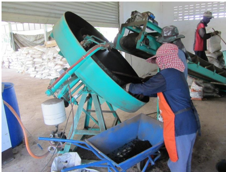
ภาพที่ 4.25 เครื่องผลิตปุ๋ยอินทรีย์ปั้นเม็ด
