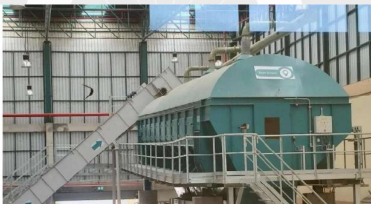
ภาพที่ 2-23 เครื่องแยกขยะแบบกรงหมุน (Drum screen)
