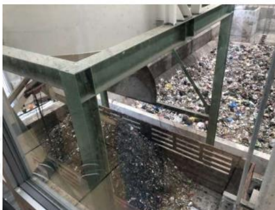
ภาพที่ 2-24 ขยะอินทรีย์ที่ออกมาจากเครื่องแยกขยะแบบจานหมุน
