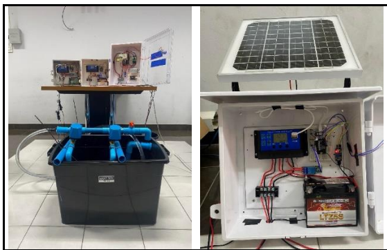
รูปที่ 6. แสดงต้นแบบและการเชื่อมวงจรอิเล็กทรอนิกส์ของตู้ควบคุม
