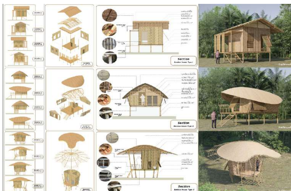
ภาพที่ 11 ผลการออกแบบบ้านไม้ไผ่ 3 แบบ ที่มีการประยุกต์ใช้ระบบ Prefabricated และ Modular
