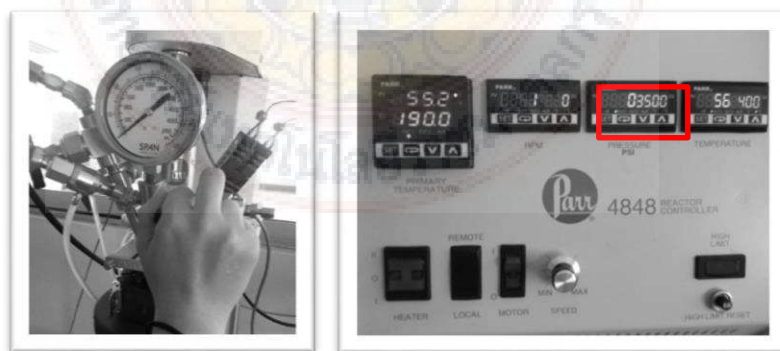
รูปที่ ฅ.2 (a) วิธีการปล่อยความดันออก (b) หน้าจอแสดงผลเมื่อปล่อยความดันออกหมด
