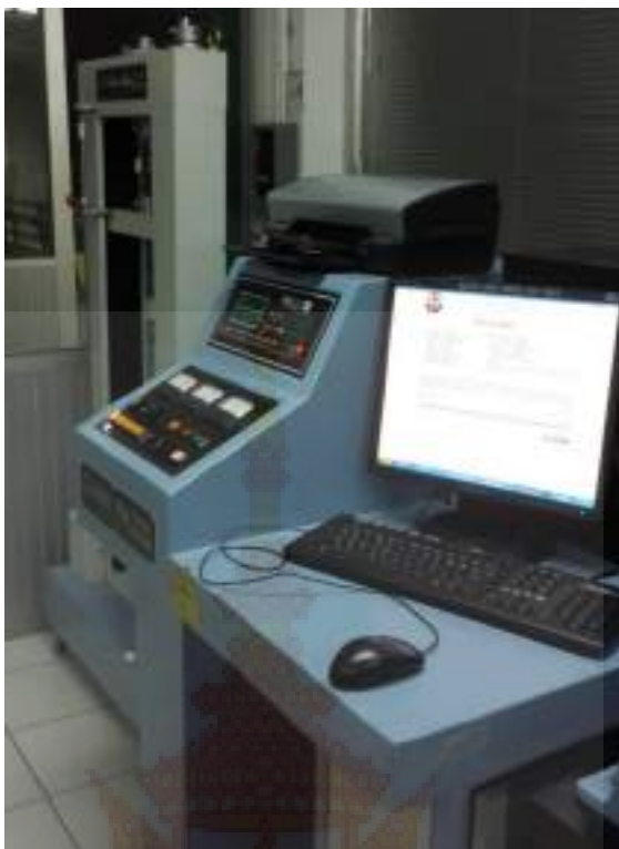
ภาพที่ 3. 29 เครื่องทดสอบทดสอบค่าแรงดึงผิวหน้า (Internal Bond)
