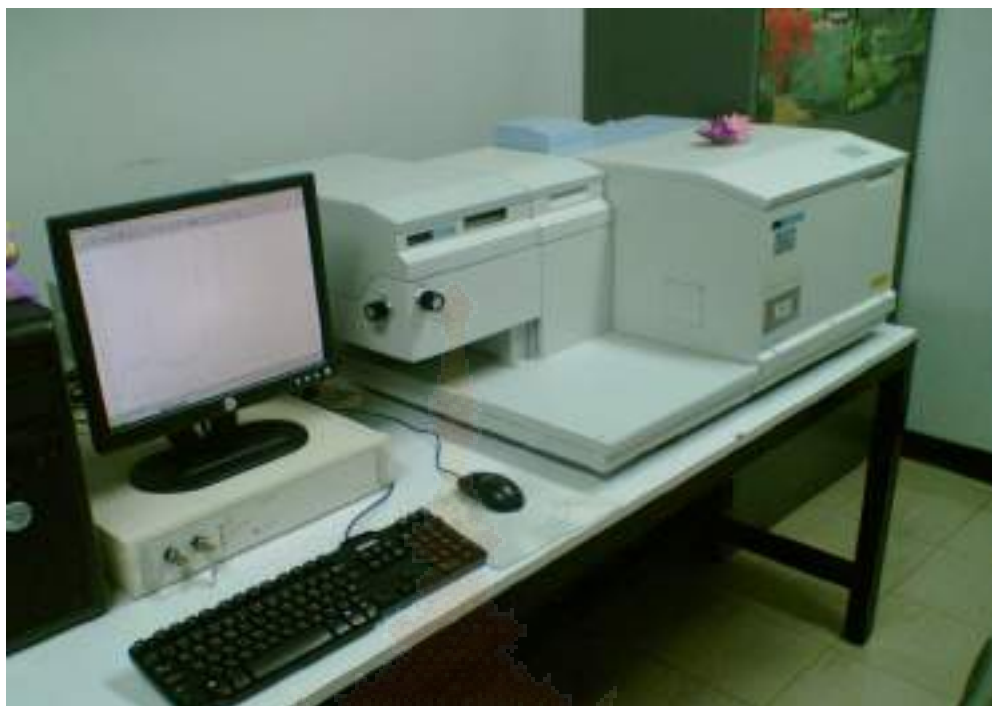
ภาพผนวกที่ 3 เครื่องฟูรีเยร์ทรานฟอร์มรามานสเปกโตรมิเตอร์ รุ่น Spectrum GX ผลิตโดยบริษัท Perkin Elmer
