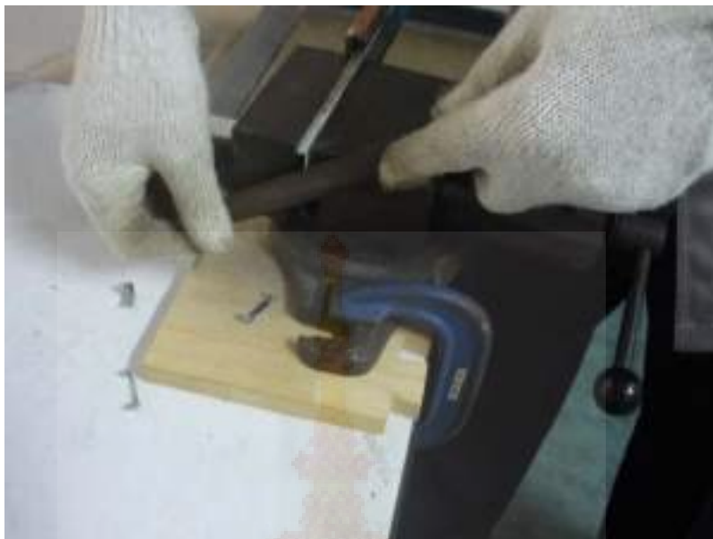
ภาพภาคผนวกที่ 11 แสดงการตักแต่งรางเลือน
