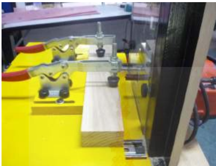
ภาพที่ 3.13 แสดงการยึดชิ้นงานติดกับแท่นเลื่อนทำงานตามลายไม้
