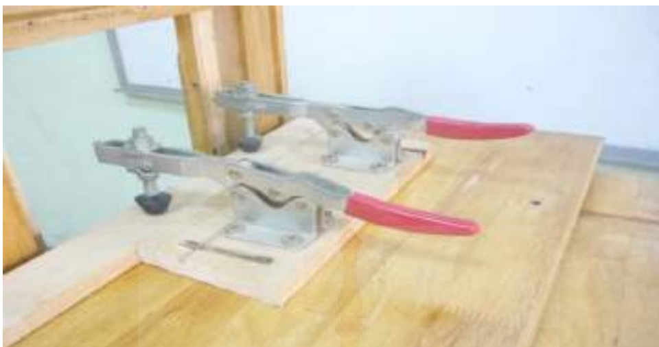
ภาพที่ 3.4 แสดงการติดตั้งตัวกดชิ้นงานเข้ากับแท่นเลื่อนรองรับชิ้นงาน
