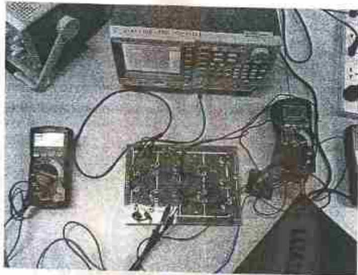
รูปที่ 4.2 แสดงการต่อขดลวดเหนี่ยวนำกับแผงวงจรเพื่อวัดค่ากระแสไฟฟ้าและความต่างศักย์
