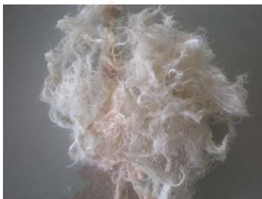
ภาพที่ 4.4 ลักษณะทางกายภาพของเส้นใยกัญชงหลังการฟอก
