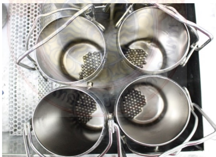
ภาพที่ 3.12 กระบอกลูกสแตนเลสและลูกสแตนเลส
