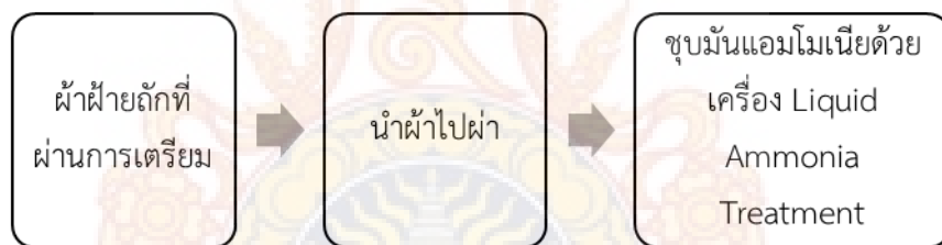
ภาพที่ 3.4 การชุบมันผ้าฝ้ายลวกด้วยแอมโมเนียเหลวในรูปแบบผ้า
