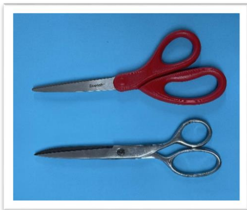
ภาพที่ 3.2 ลักษณะกรรไกรด้ามตรง
