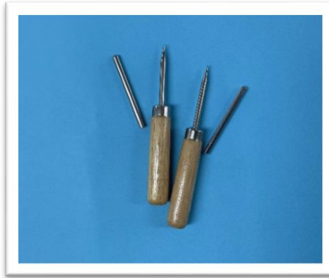
ภาพที่ 3.6 ลักษณะเหล็กแหลม
