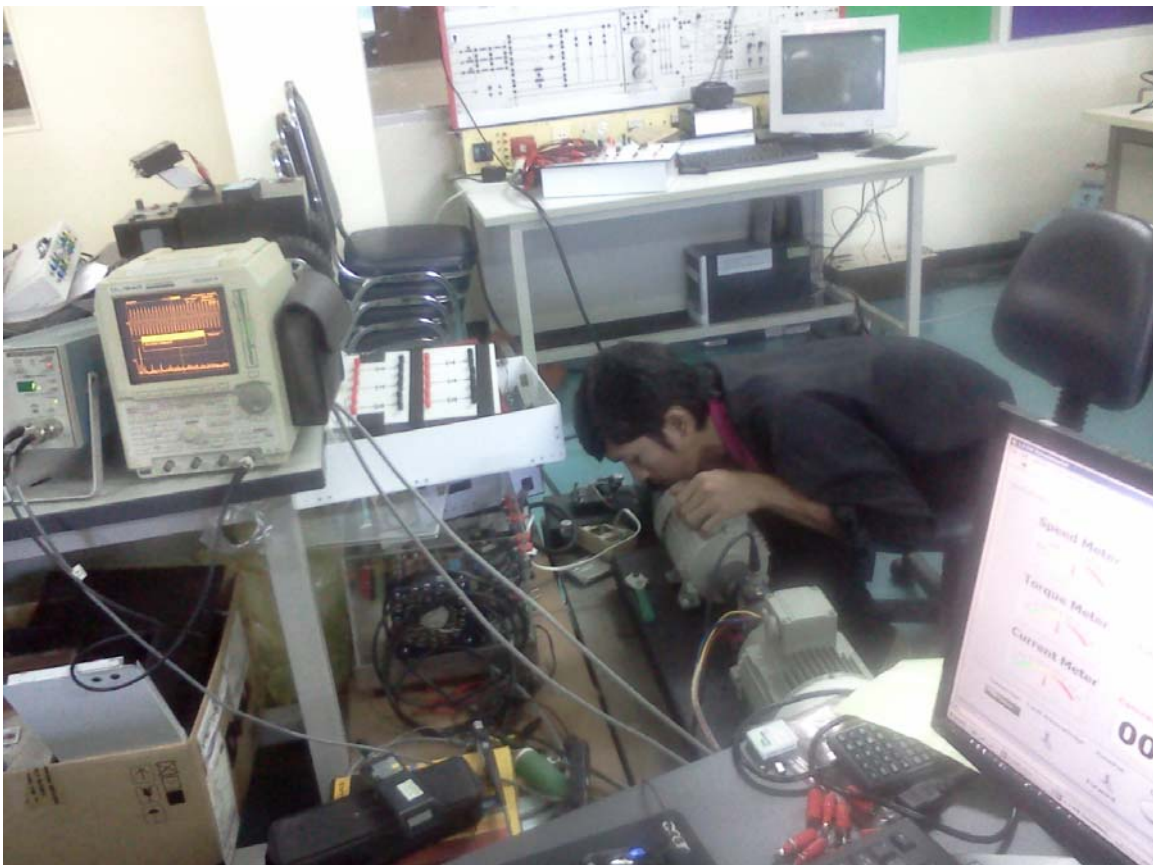
รูปที่ 4.28 ภาพขณะทำการทดลองเปลี่ยนมอเตอร์
