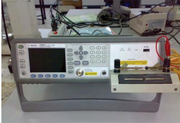
รูปที่ 3.9 แสดงเครื่อง E4980A 20 Hz – 2 MHz Precision LCR meter
