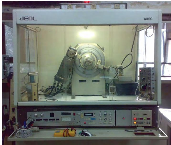
รูป 3.8 แสดงเครื่อง X-ray diffractometer
