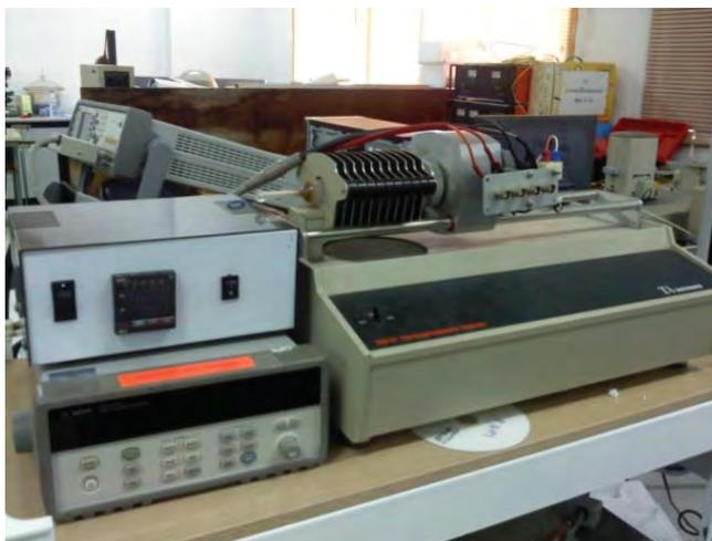
รูป 3.10 แสดงชุดควบคุมและประมวลผลเพื่อทดสอบสมบัติไดอิเล็กทริกเทียบกับอุณหภูมิ
