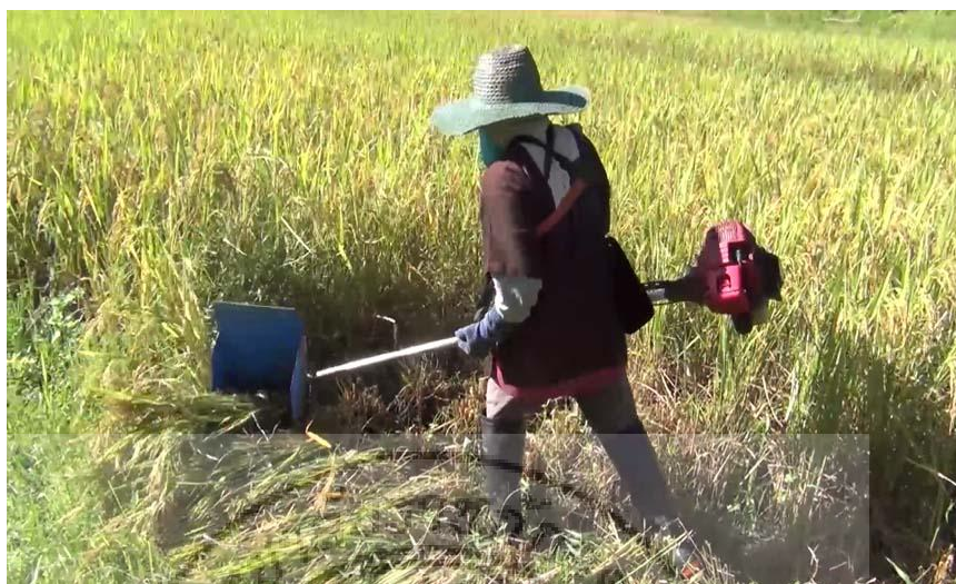
ภาพ 4.3 การใช้เครื่องตัดหญ้าตัดแปลงเป็นเครื่องตัดเกี่ยวข้าว
