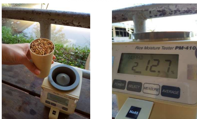
ภาพที่ 3.6 วัดค่าความชื้นเมล็ดพันธุ์ข้าวผ่านเครื่อง Rice Moisture Tester
