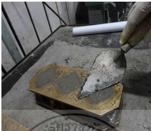
ภาพที่ 3.1 นำส่วนผสมที่ผสมจนเข้ากันได้ดีใส่เข้าแบบหล่อขนาด 50 \times 50 \times 50 มม 3 ปาดผิวหน้าชิ้นงานให้เรียบด้วยเกรียง
