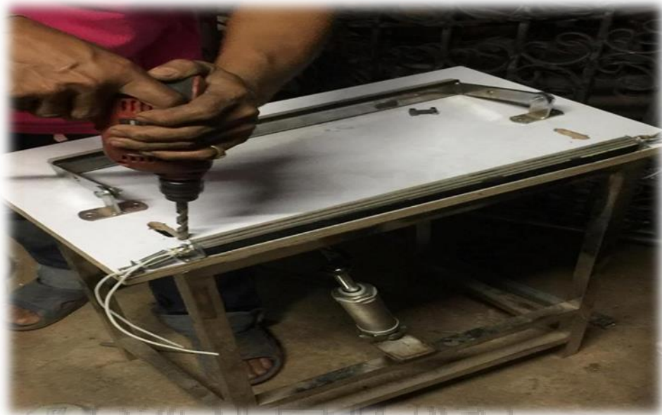
ภาพ 3.8 แสดงภาพทำการเจาะช่องเพื่อทำการยึดแขนปิดผนึก
