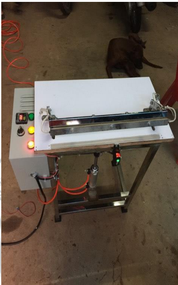
ภาพ 3.12 แสดงภาพโครงสร้างจริงของการพัฒนาเครื่องปิดผนึกบรรจุภัณฑ์พลาสติกด้วยกระบวนการมีส่วนร่วมของสถานประกอบการ
