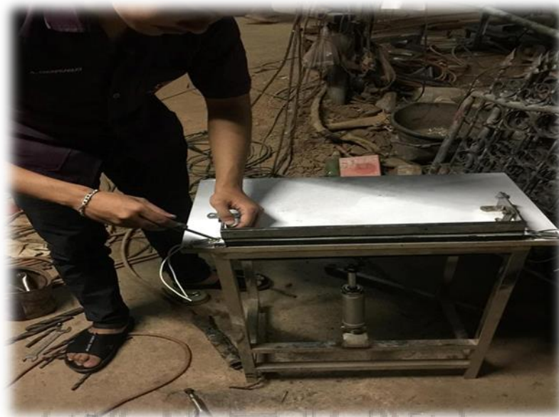
ภาพ 3.10 แสดงภาพทำการยึดแขนปิดผนึกถุงพลาสติกให้แน่น
