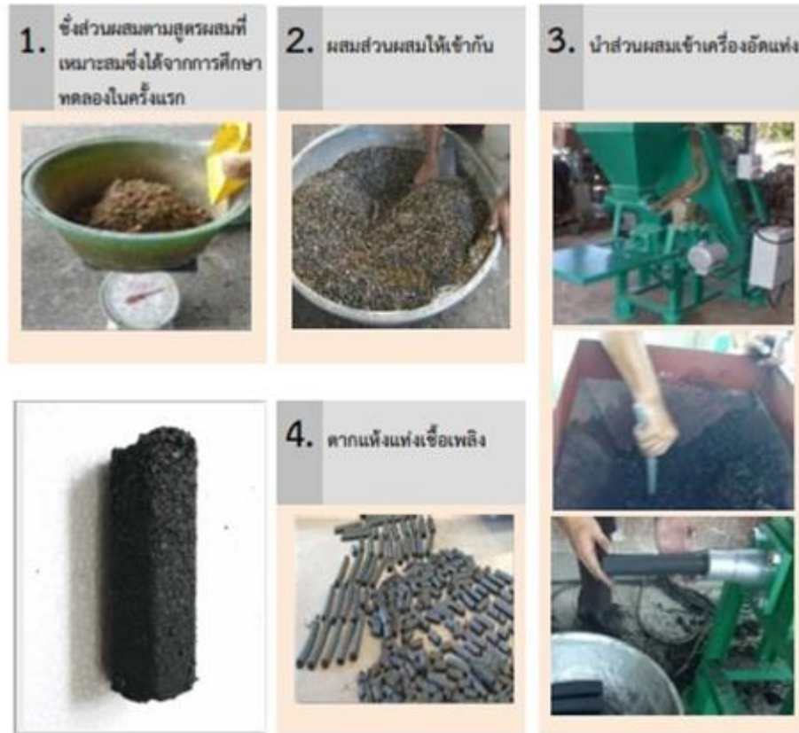
ภาพที่ 3 เครื่องอัดและกระบวนการผลิต ที่มา:คู่มือแนวทางและเกณฑ์คุณสมบัติเพื่อการแปรรูปเป็นแท่งเชื้อเพลิง กรมโรงงานอุตสาหกรรม
