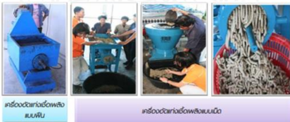
ภาพที่ 4 เครื่องมือที่ใช้ในการผลิตเชื้อเพลิงแท่ง ที่มา:คู่มือแนวทางและเกณฑ์คุณสมบัติเพื่อการแปรรูปเป็นแท่งเชื้อเพลิง กรมโรงงานอุตสาหกรรม
