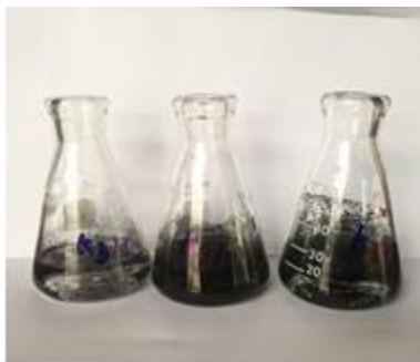
ภาพที่ 16 ถ่านกัมมันต์จากกากกาแฟที่ผ่านการกระตุ้นทางเคมี
