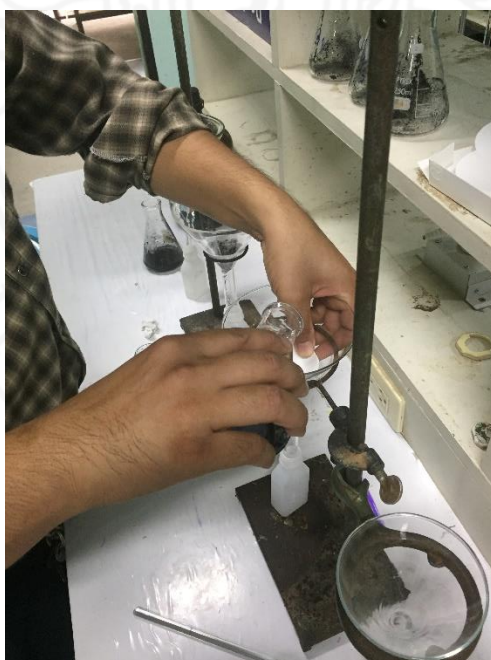
ภาพที่ 15 การกรองถ่านจากกากกาแฟเพื่อนำไปตรวจสอบการดูดซับ
