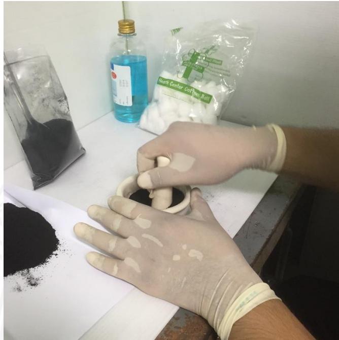
ภาพที่ 12 การบดถ่านที่ได้จากกากกาแฟ
