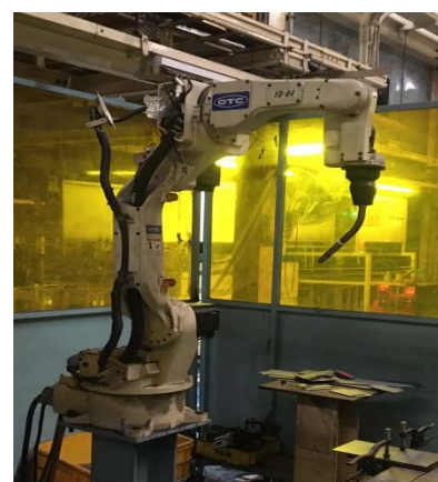
b. Welding robot.
