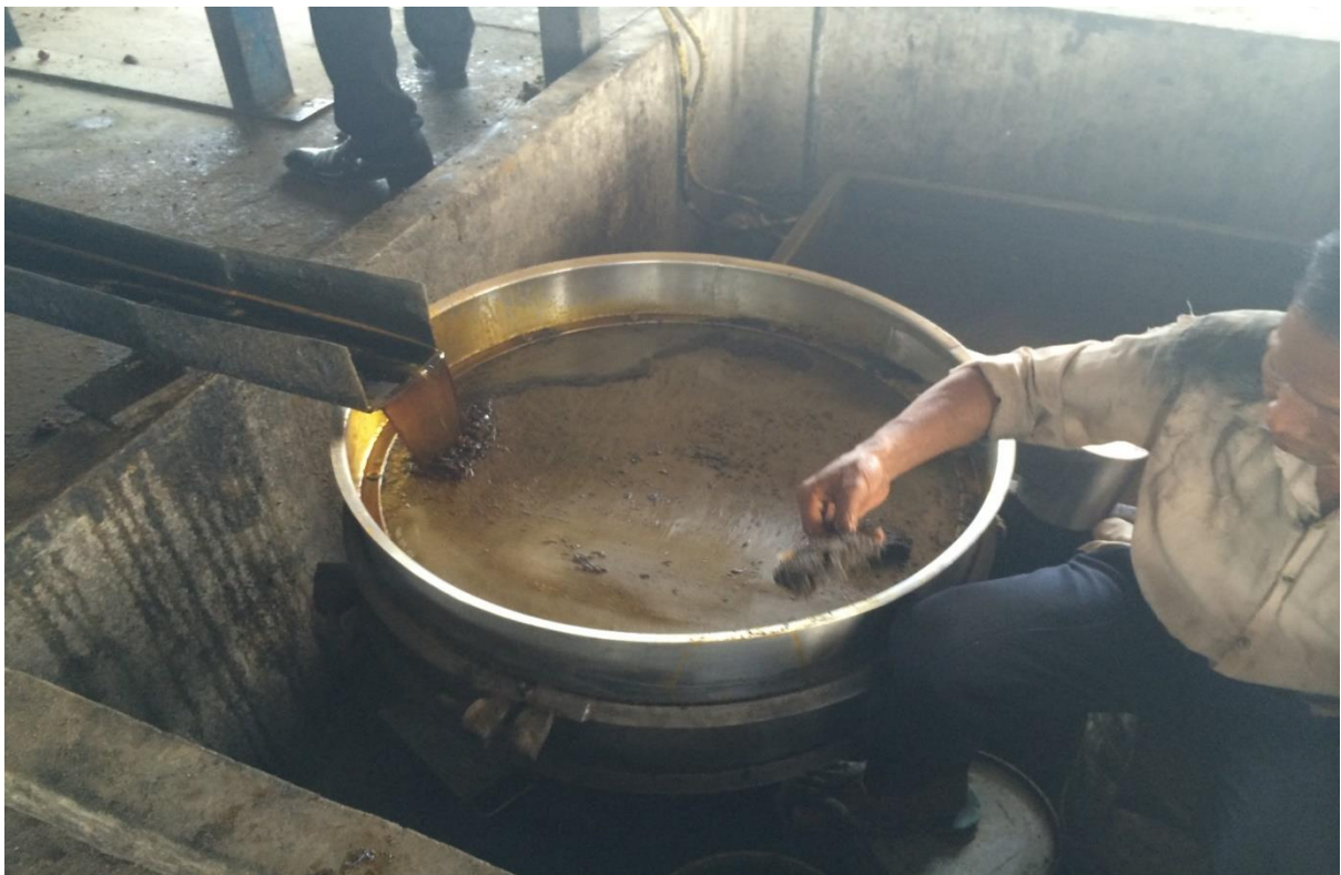
ภาพ 37 น้ำมันปาล์มดิบที่ผ่านกระบวนการบีบน้ำมันจากเครื่องจักร ที่มา: จากการลงพื้นที่สำรวจโดยคณะวิจัย (2557)
