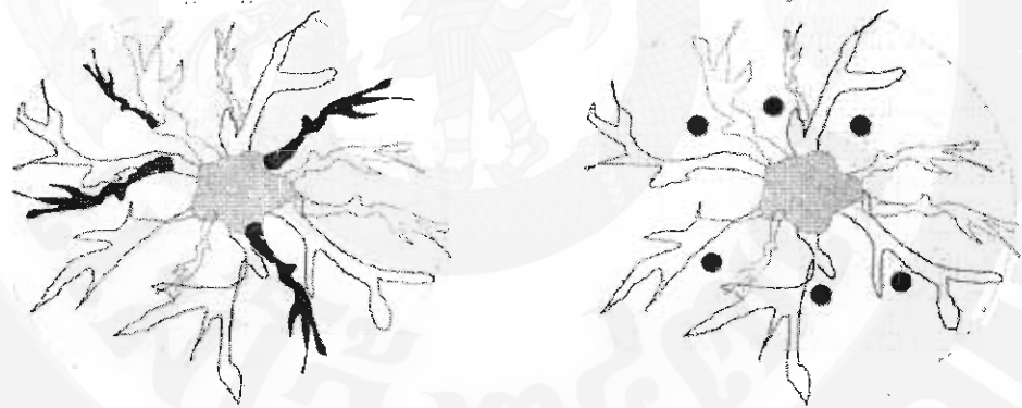
1 สภาพต้นน้ำจืด โถงบนผิวทาง โคนต้นไม้ปลูกด้วยระบบน้ำหยด 2-3 การขุดเจาะบริเวณ รอบโคนไม้เพื่อ สานทางและใส่ท่อ พีวีซี
