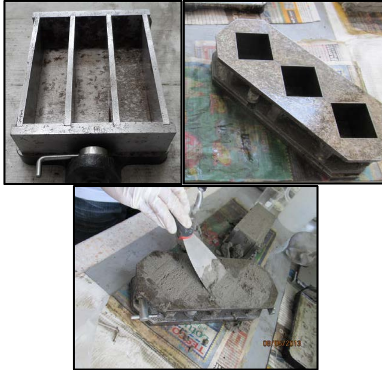
รูปที่ 2 เทส่วนผสมลงในแม่พิมพ์ที่เตรียมไว้
