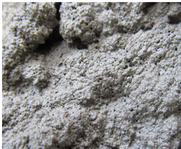
รูปที่ 20 แสดงฟองอากาศขนาดเล็กของซีเมนต์เพสต์ผสมน้ำยางพาราชั้นเมื่อเติมสารลดแรงตึงผิว NP-9
