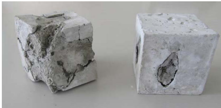
รูปที่ 19 แสดงการจับตัวกันของเนื้อยางพาราในชิ้นงานทรงลูกบาศก์ ขนาด 5x5x5 ลบ.ซม.
