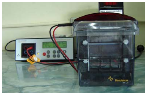
ภาพที่ 2 การต่อเครื่อง mini VE เข้ากับเครื่องจ่ายกระแสไฟฟ้าเพื่อทำ SDS-PAGE
