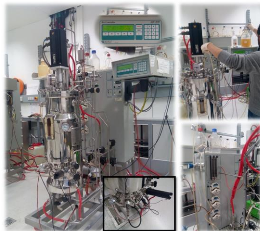
ภาพที่ 6 แสดงลักษณะของถังหมักชนิด stirred tank bioreactor ขนาด 50 ลิตร ที่ใช้การทดลองหมักแบบกะ
