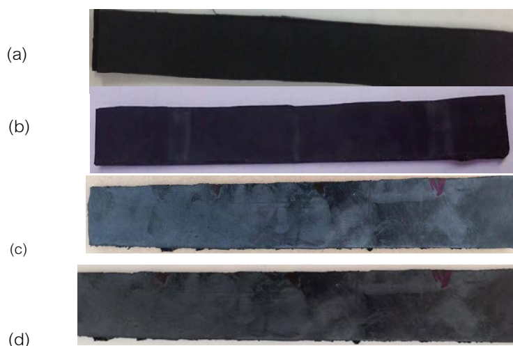
ภาพที่ 9 แสดง (a) ตัวอย่าง STR20-HP30 ที่ผ่านการพียงอกก่อนการบ่มเร่ง (b) ตัวอย่าง STR20-HP30 ที่ผ่านการพียงอหลังการบ่มเร่ง (c) ตัวอย่าง RSS3-HP30 ที่ผ่านการพียงอกก่อนการบ่ม แล (d) ตัวอย่าง RSS3-HP30 ที่ผ่านการพียงอหลังการบ่ม
