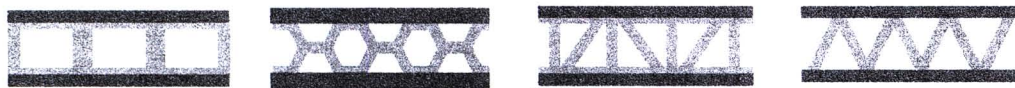
ภาพที่ 2.13 วัสดุ CFRP รูปแบบต่าง ๆ นำมารวมเป็นแผ่นพื้น (Aixi Zhou, 2002)
