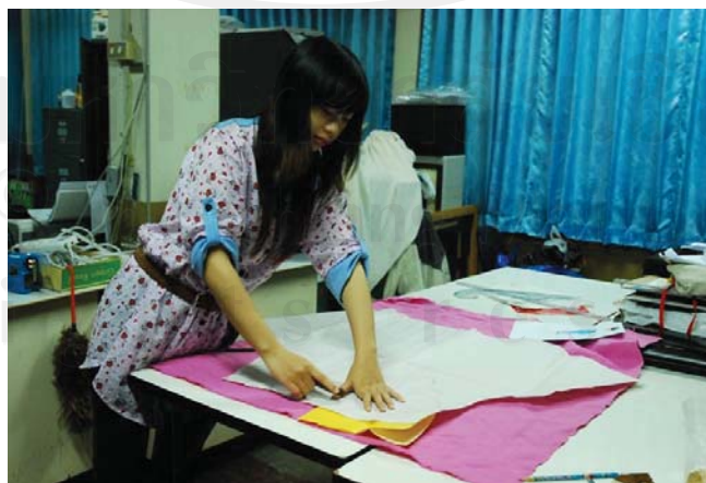
ภาพที่ 4.25 ขั้นตอนการสร้างแบบตัดและการวางแบบตัดเสื้อผ้า
