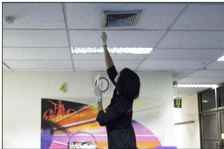
ภาพที่ 3.2 การเก็บตัวอย่างเชื้อราในเครื่องปรับอากาศด้วยวิธีการสวอป (Swab)
