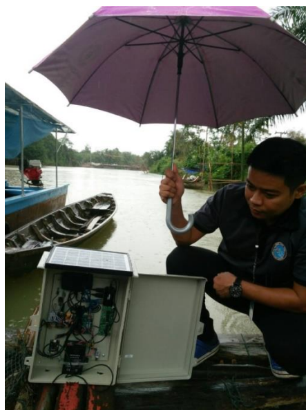
ภาพที่ 4.9 ระบบตรวจวัดคุณภาพน้ำและแอปพลิเคชันเพื่อการเฝ้าระวังคุณภาพน้ำและเตือนภัยบนโทรศัพท์มือถือ
