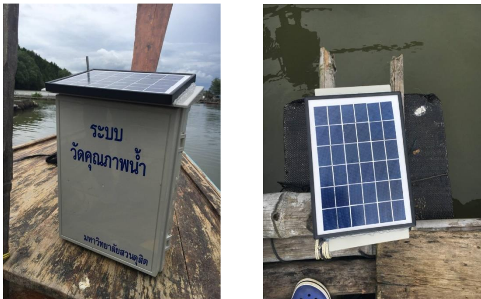
ภาพที่ 4.6 ระบบตรวจวัดคุณภาพน้ำต้นแบบ
