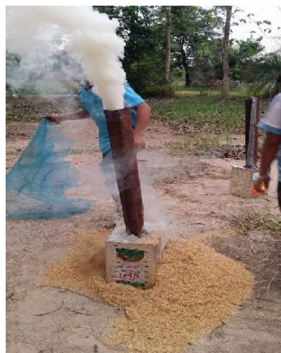
รูปที่ 3.8 ใส่แกลบรอบๆ ปี้บที่จุดไฟแล้วจนท่วมปี้บ
