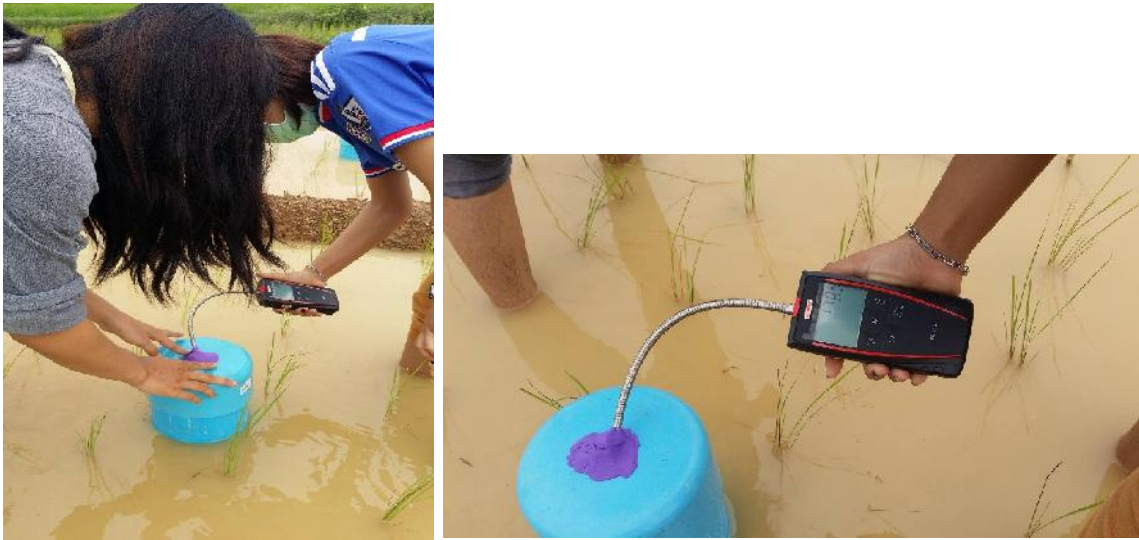
รูปที่ 3.17 การวัดก๊าซมีเทน ( \text{CH}_4 ) ในนาข้าวโดยใช้เครื่องวัดก๊าซ ยี่ห้อ KIMO รุ่น FG110
