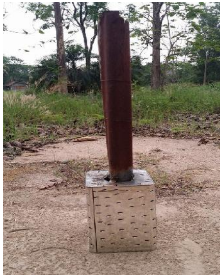
รูปที่ 3.7 ปี้บสังกะสีเจาะที่ใช้ในการเผาถ่านแกลบ
