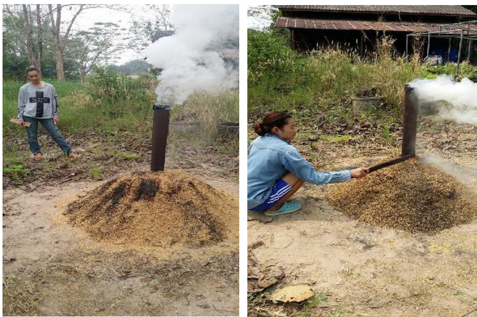
รูปที่ 3.9 การเผาถ่านแกลบที่ต้องคอยเฝ้าให้เกิดการไหม้ที่ทั่วถึง
