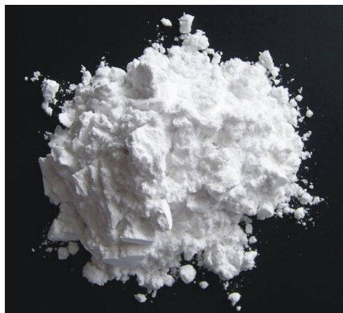
รูปที่ 2.9 อะลูมิเนียมออกไซด์ ( \text{Al}_2\text{O}_3 )
