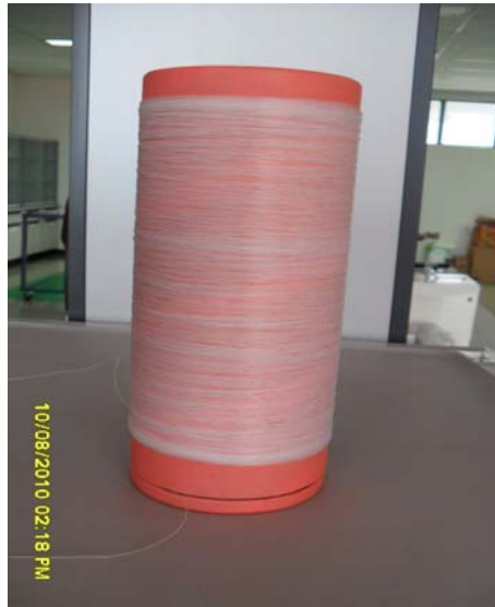
รูปที่ 4.14 แสดงเส้นใยที่ดึงจากของพอลิเอทิลีนเทอร์เฟธาเลตเกรดรีไซเคิลกับพอลิโพรพิลีนเกรดรีไซเคิลในอัตราส่วน 95/5/C
