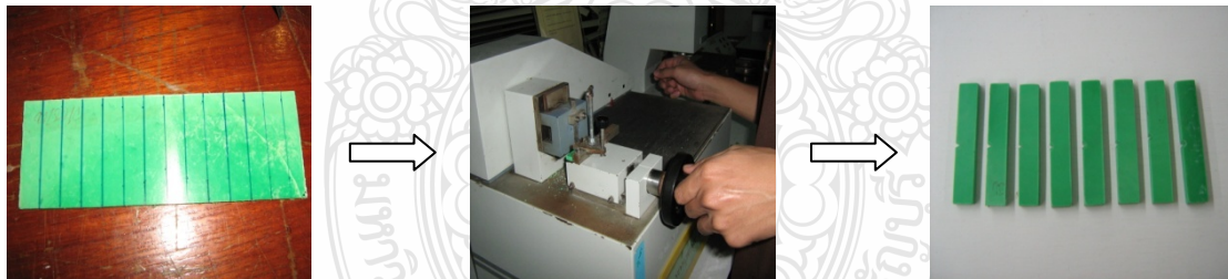
รูปที่ 3.6 แสดงขั้นตอนการเตรียมชิ้นงานทดสอบการทนต่อแรงกระแทก
