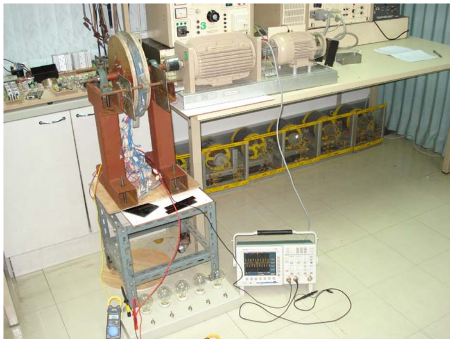
รูปที่ 4.9 แสดงการทดสอบเครื่องกำเนิดไฟฟ้าในสถานะมีโหลด
