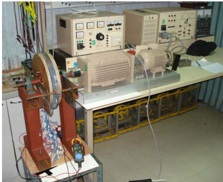
รูปที่ 4.1 แสดงการทดสอบเครื่องกำเนิดในสภาวะไม่มีโหลด
