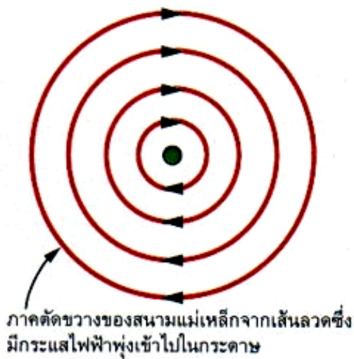
รูปที่ 2.5 ภาพตัดขวางของสนามแม่เหล็ก
