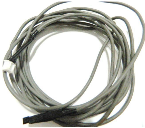
รูปที่ 3.18 อุปกรณ์ตรวจจับสัญญาณอุณหภูมิที่ติดตั้งใช้งานจริง
