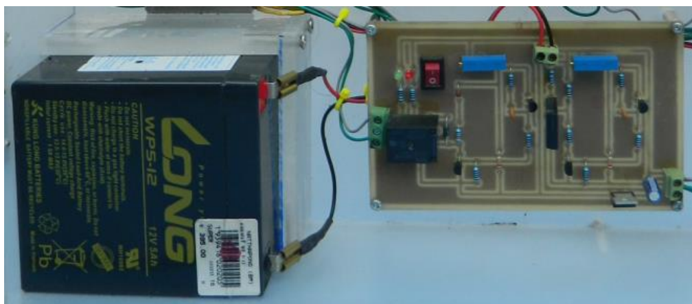
รูปที่ 3.28 แบตเตอรี่สำรองพร้อมวงจรชาร์จ
