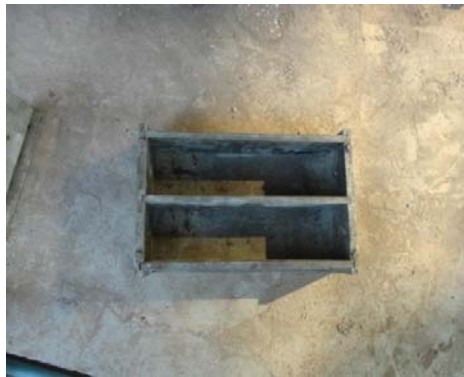
ภาพที่ 3.2 แบบหล่อขึ้นตัวอย่างคอนกรีต
