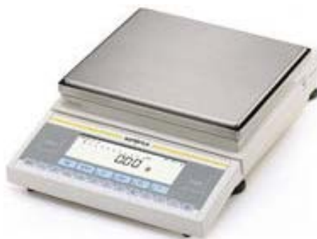
ภาพที่ 3.4 เครื่องชั่งดิจิทัล ความละเอียด 0.01 กรัม
