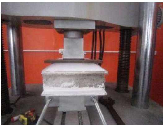
รูปที่ 3.18 การทดสอบความต้านทานแรงดัดของบล็อกปูพื้นจากเศษหินภูเขาไฟด้วยเครื่อง UTM
