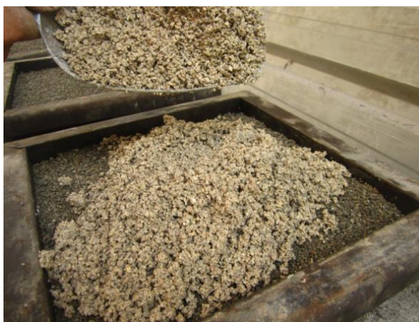
รูปที่ 3.15 การเทส่วนผสมส่วนผิวหน้าลงในแบบหล่อของบล็อกปูพื้นจากเศษหินภูเขาไฟ
