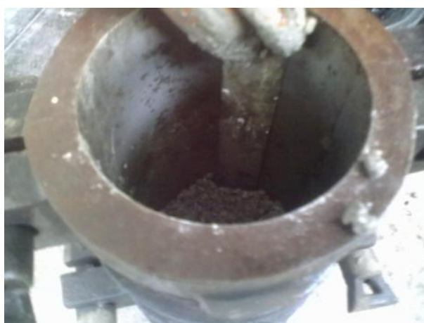
รูปที่ 3.20 การขึ้นรูปบล็อกปูพื้นจากเศษหินภูเขาไฟสำหรับทดสอบการระบายน้ำ
