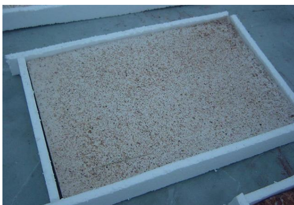
รูปที่ 3.25 กระจับเบื้องหินล้างสีเหลืองสำหรับทดสอบอุนทงูมิผิวหน้า
