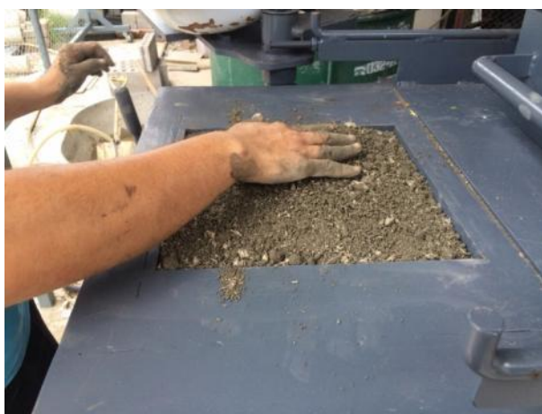
รูปที่ 3.12 การจัดเรียงส่วนผสมให้พร้อมต่อการอัดขึ้นรูปบล็อกปูพื้นจากเศษหินภูเขาไฟส่วนฐาน
