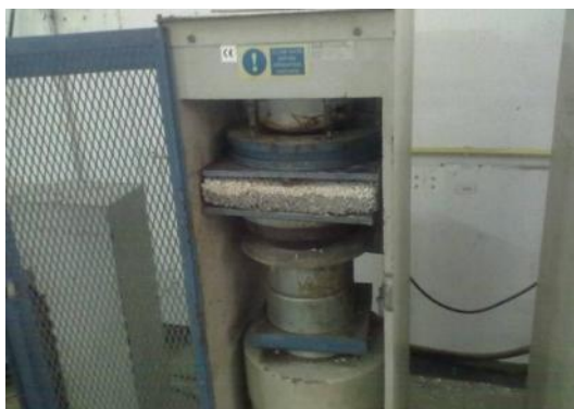
รูปที่ 3.19 การทดสอบความต้านทานแรงอัดของบล็อกปูพื้นจากเศษหินภูเขาไฟด้วยเครื่อง UTM
