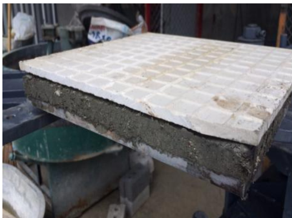
รูปที่ 3.14 บล็อกปูพื้นจากเศษหินภูเขาไฟส่วนฐานภายหลังการอัดขึ้นรูป
