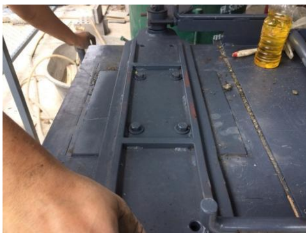
รูปที่ 3.13 การอัดขึ้นรูปบล็อกปูพื้นจากเศษหินภูเขาไฟส่วนฐานด้วยเครื่องอัดบล็อกปูพื้น
