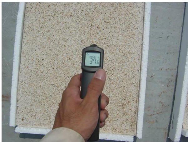
รูปที่ 3.26 การวัดอุณหภูมิผิวหน้าด้วยอินฟราเรดเทอร์โมมิเตอร์
