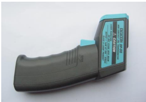
รูปที่ 3.7 อินฟราเรดเทอร์โมมิเตอร์
