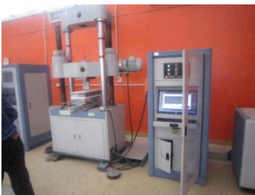
รูปที่ 3.17 เครื่องทดสอบอเนกประสงค์ (Universal Testing Machine)
