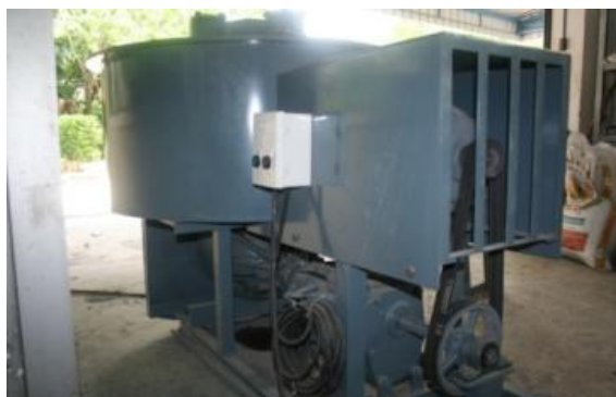
รูปที่ 3.3 เครื่องผสมคอนกรีต
