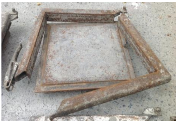
รูปที่ 3.6 แบบหล่อคอนกรีตบล็อกตันแบบถอดประกอบได้ ขนาด 30x30x5 ลูกบาศก์เซนติเมตร
