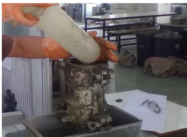
รูปที่ 3.22 เทน้ำลงในแบบหล่อบล็อกปูพื้นทรงกระบอกจากเศษหินภูเขาไฟพร้อมจับเวลา
