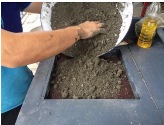
รูปที่ 3.11 การเทส่วนผสมสำหรับส่วนฐานลงในเครื่องอัดขึ้นรูปบล็อกปูพื้นจากเศษหินภูเขาไฟ
