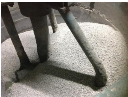
รูปที่ 3.10 การผสมวัสดุสำหรับขึ้นรูปบล็อกปูพื้นจากเศษหินภูเขาไฟ
