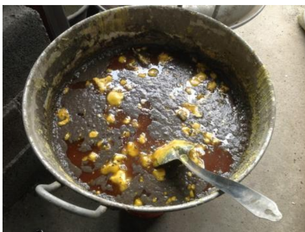
รูปที่ 3.14 กำมะถันที่ใช้เคลือบผิวหน้าบล็อกประสานผสมเศษหินภูเขาไฟ
