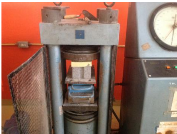
รูปที่ 3.16 การทดสอบความต้านทานแรงอัดของบล็อกประสานผสมเศษหินภูเขาไฟ
