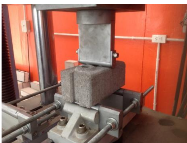
รูปที่ 3.17 การทดสอบโมดูลัสการแตกหักของบล็อกประสานผสมเศษหินภูเขาไฟ
