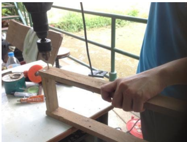
รูปที่ 3.13 การทำแบบหล่อผิวหน้าของบล็อกประสานผสมเศษหินภูเขาไฟสำหรับเคลือบด้วยกำมะถัน
