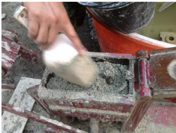
รูปที่ 3.8 การขึ้นรูปบล็อกประสานผสมเศษหินภูเขาไฟด้วยเครื่องอัดบล็อกประสานแบบมือโยก
