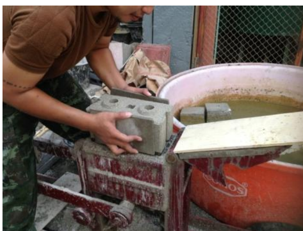
รูปที่ 3.10 การนำบล็อกประสานผสมเศษหินภูเขาไฟออกจากเครื่องอัดบล็อกประสานแบบมือโยก
