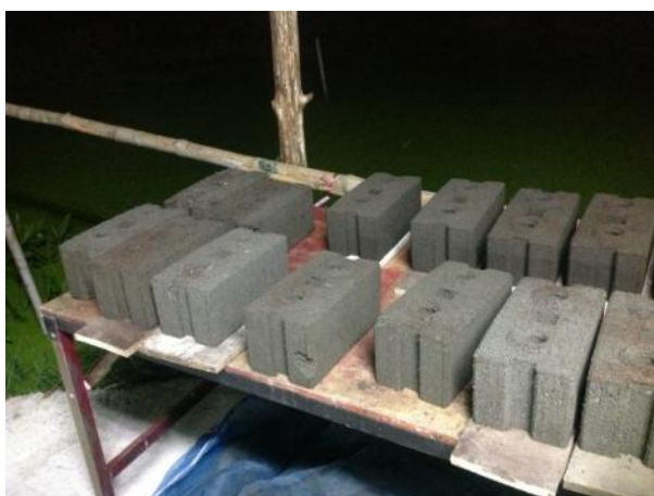
รูปที่ 3.12 การจัดเรียงบล็อกประสานผสมเศษหินภูเขาไฟสำหรับการบ่ม
