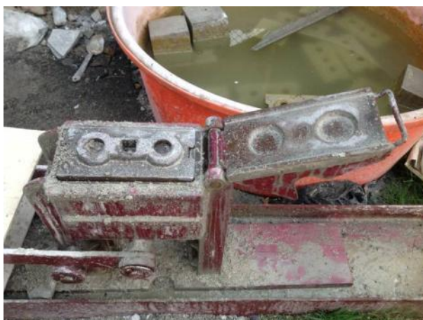
รูปที่ 3.3 เครื่องอัดบล็อกประสานแบบมือโยก
