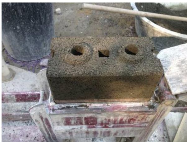
รูปที่ 3.9 บล็อกประสานผสมเศษหินภูเขาไฟที่ขึ้นรูปด้วยเครื่องอัดบล็อกประสานแบบมือโยก
