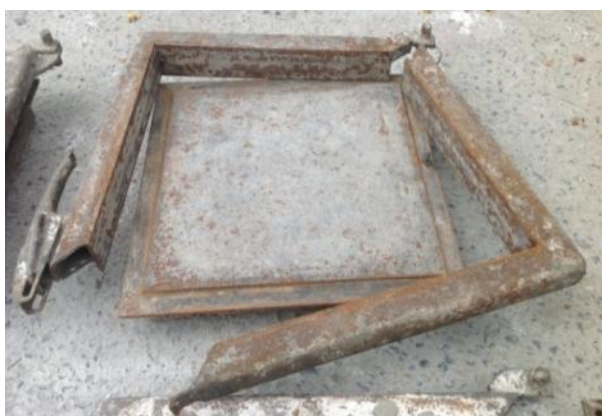
รูปที่ 3.4 แบบหล่อบล็อกประสาน ขนาด 30x30x5 ลูกบาศก์เซนติเมตร
