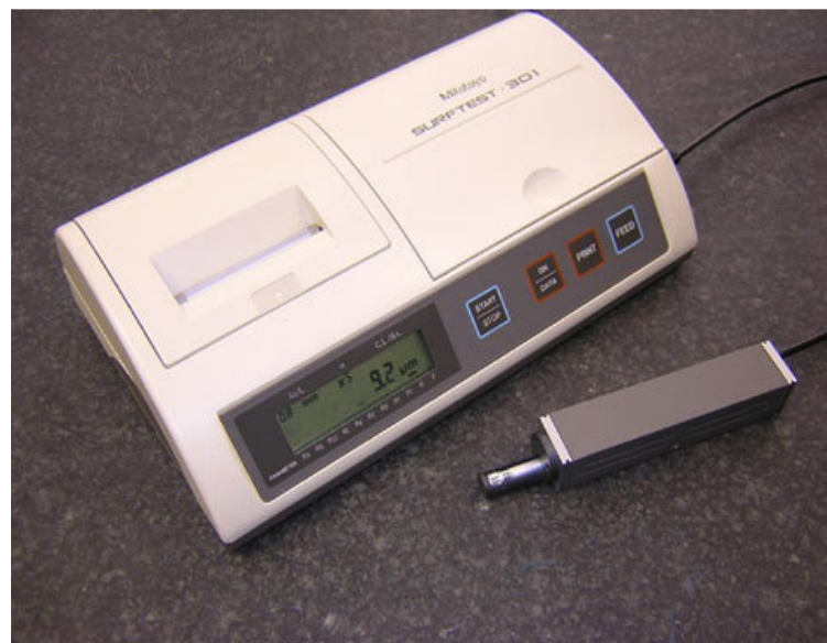
ภาพที่ 3.7 เครื่องวัดความเรียบผิวของชิ้นงาน
