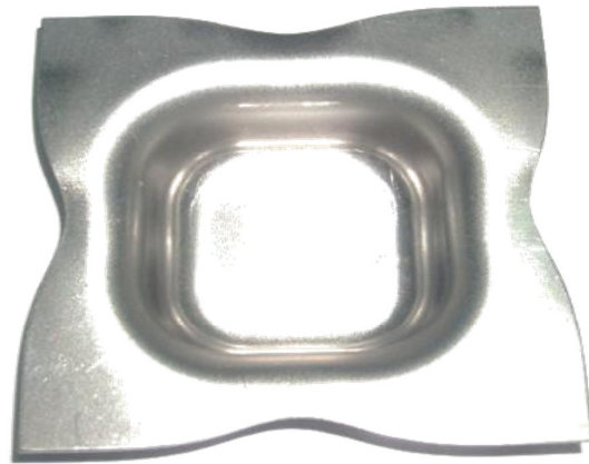
ภาพที่ 3.19 ชิ้นงานจากการทดสอบแม่พิมพ์ครั้งที่ 1
