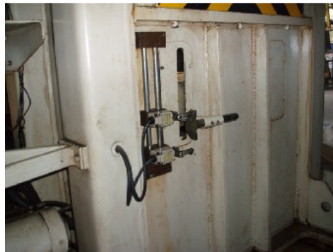
ภาพที่ 3.17 การตั้งลิimitsวิตช์ (Limit Switch)
