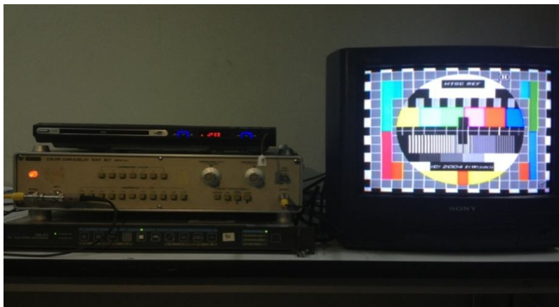
รูปที่ 2.13 การแสดงผลกระทบของความผิดเพี้ยนทางเวลาประวิงอย่างเฉียวที่มีต่อสัญญาณวิดีโอจริง
