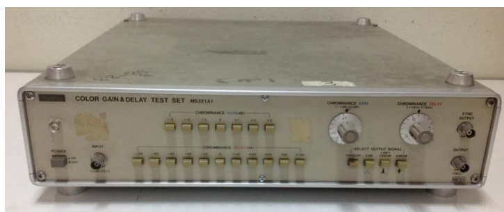
รูปที่ 2.10 เครื่อง Color Gain & Delay Test Set MS321A
