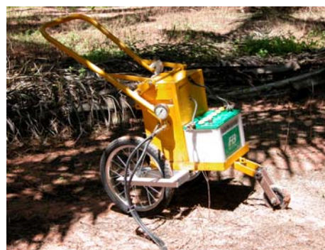
ภาพที่ 25 ชุดปั๊มไฮดรอลิกที่เปลี่ยนเป็นล้อใหญ่
