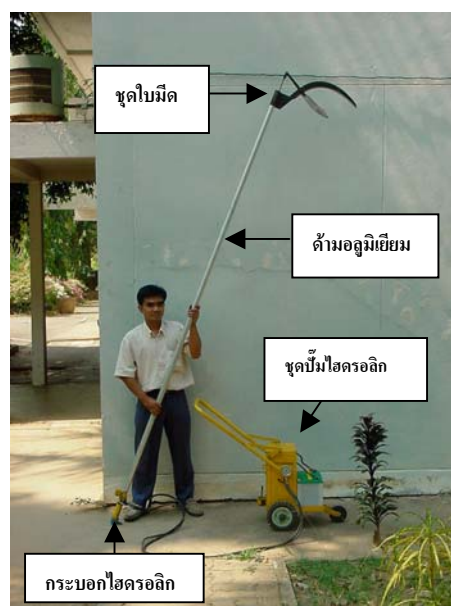
ภาพที่ 13 ชุดปั๊มไฮดรอลิกและด้ามเครื่องต้นแบบเบอร์ 1
