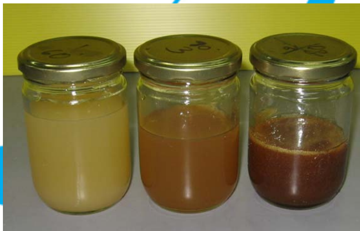
แผนภาพที่ 5 ไชร์ปข้าวที่มีปริมาณของแข็งที่ละลายน้ำได้เท่ากับ 60 70 และ 80 ° Brix (จากซ้ายไปขวา)
