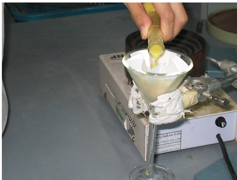
ภาพที่19 การกรองตัวอย่างนมแพะผ่านกระดาษกรอง
