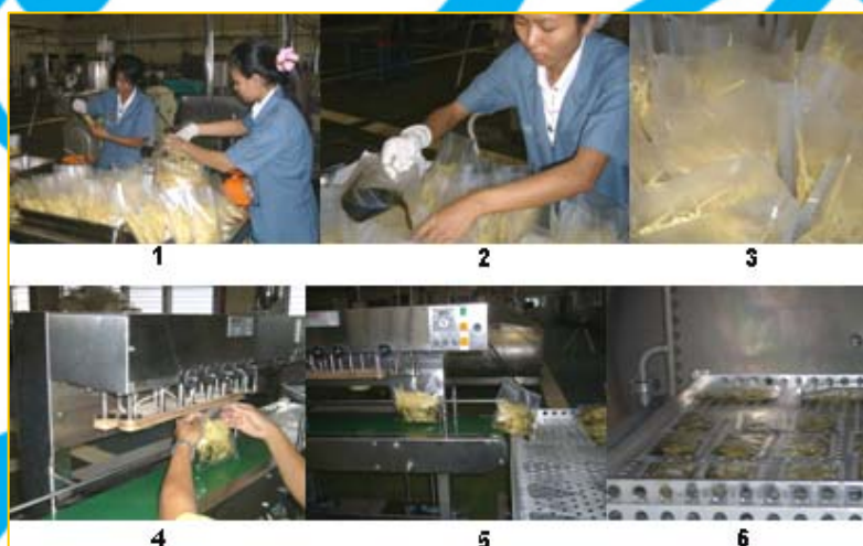
ภาพที่ 8 กระบวนการผลิตหน่อไม้อัดน้ำต้มโยย่านางในรีทอร์ท เพาซ์
