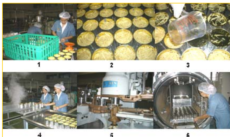
ภาพที่ 7 กระบวนการผลิตหน่อไม้อัดน้ำต้มโยย่านางในกระป๋อง
