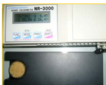
ภาพที่ 9 เครื่องวัดสี (Handy Colorimeter/ Nippon Denshoku NR – 3000)
