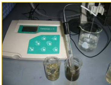
ภาพที่ 11 เครื่องวัดค่า pH meter (Cyberscan 510)
