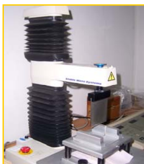
ภาพที่ 10 เครื่องวัดเนื้อสัมผัส (Texture Analyzer รุ่น TA – XTi2 Stable Micro System)
