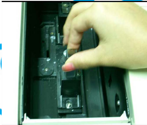
ภาพผนวกที่ 32 การวิเคราะห์หาค่าฟอสฟอรัสด้วยเครื่อง Ultraviolet-Visible Spectrophotometer
