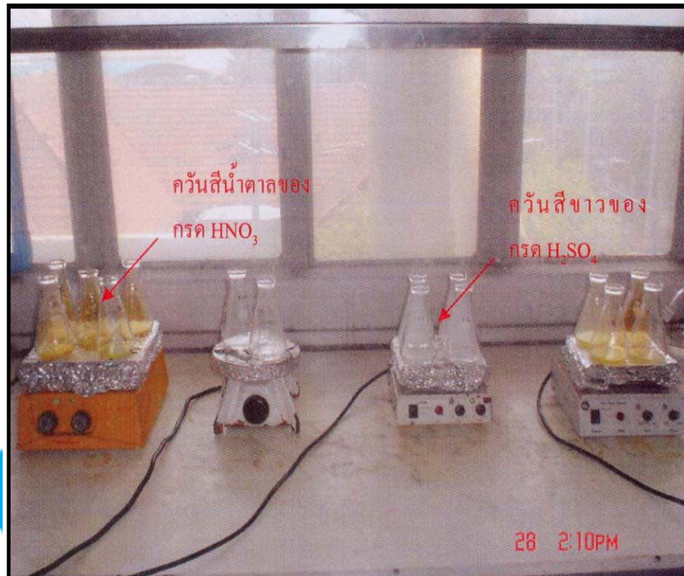
ภาพผนวกที่ 29 ทำการ Digestion จนกระทั่งควันสีน้ำตาลของกรด \text{HNO}_3 จนหมด และควันสีขาวของ กรด \text{H}_2\text{SO}_4 ให้เหลือน้อยที่สุด
