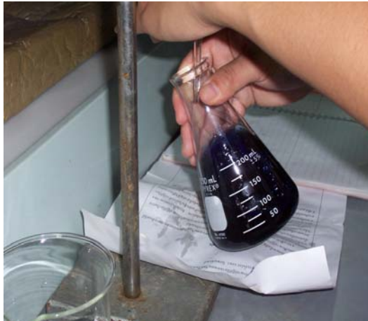
ภาพผนวกที่ 23 การTritrate ตัวอย่างด้วยกรดซัลฟูริก 0.5 N.
