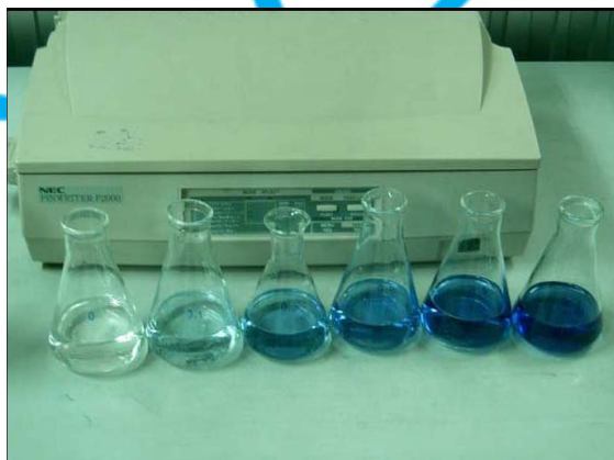
ภาพผนวกที่ 30 สารละลายมาตรฐานที่เตรียมนำไปวัดค่าการดูดกลืนแสงที่ความยาวคลื่น 880 นาโนเมตร ด้วย Ultraviolet-Visible Spectrophotometer
