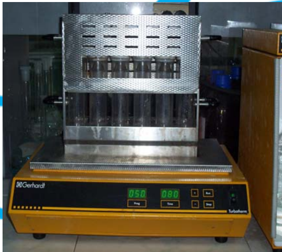
ภาพผนวกที่ 21 การ Digest ตัวอย่างเพื่อการวิเคราะห์หาไนโตรเจน
