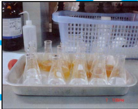
ภาพผนวกที่ 24 สารละลายมาตรฐานและน้ำตัวอย่างที่เตรียมทำการ Digestion บน Hot plate
