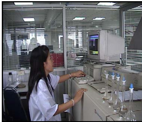
ภาพผนวกที่ 26 การวิเคราะห์ค่าโพแทสเซียมด้วยเครื่อง ICPS
