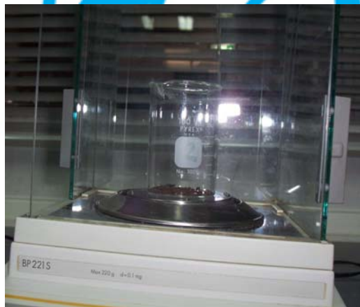
ภาพผนวกที่ 19 ชั่งตัวอย่างเพื่อวิเคราะห์หาค่าไนโตรเจน
