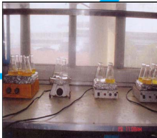
ภาพผนวกที่ 27 นำสารละลายมาตรฐานและน้ำตัวอย่าง Digestion บน Hot plate
